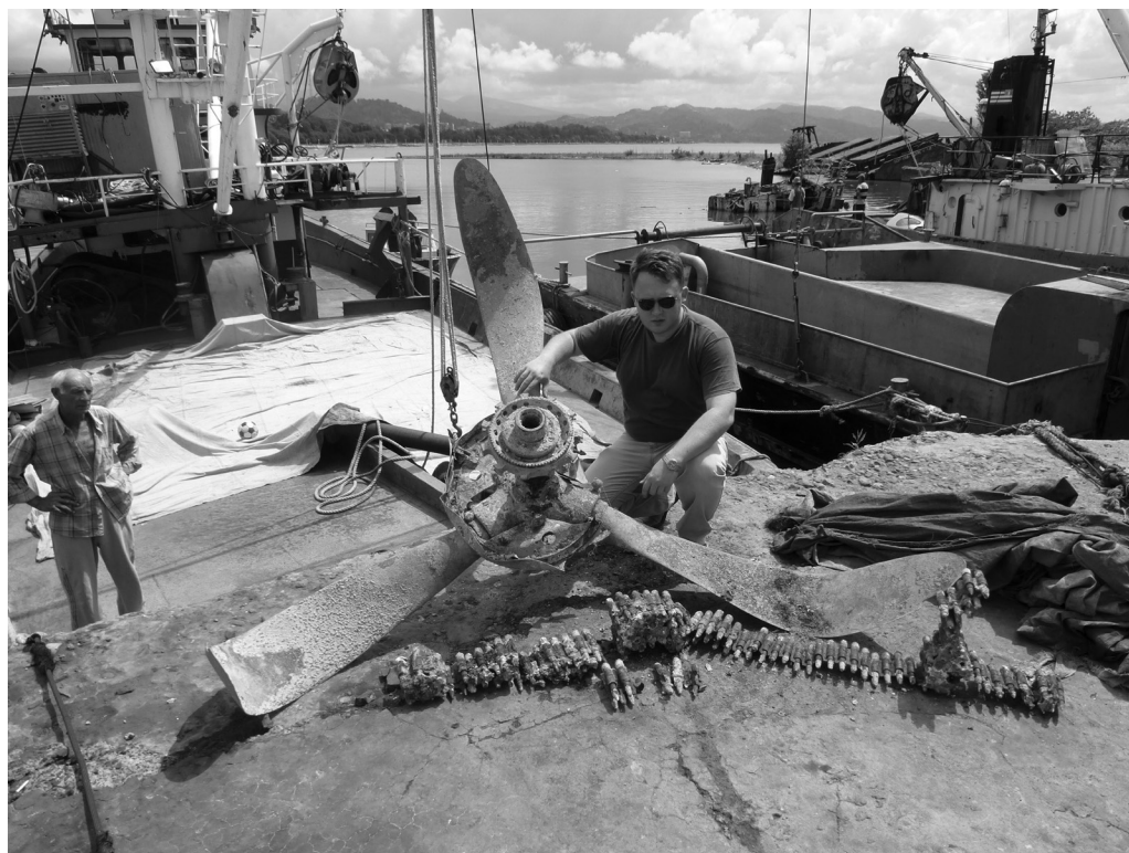
Винт и фрагменты боекомплекта от истребителя ЛаГГ-3 Николая Сикова в Сухумском морпорту
