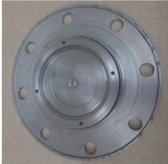
Рис. 4. Фотография изолированного охлаждаемого водой катодного узла
