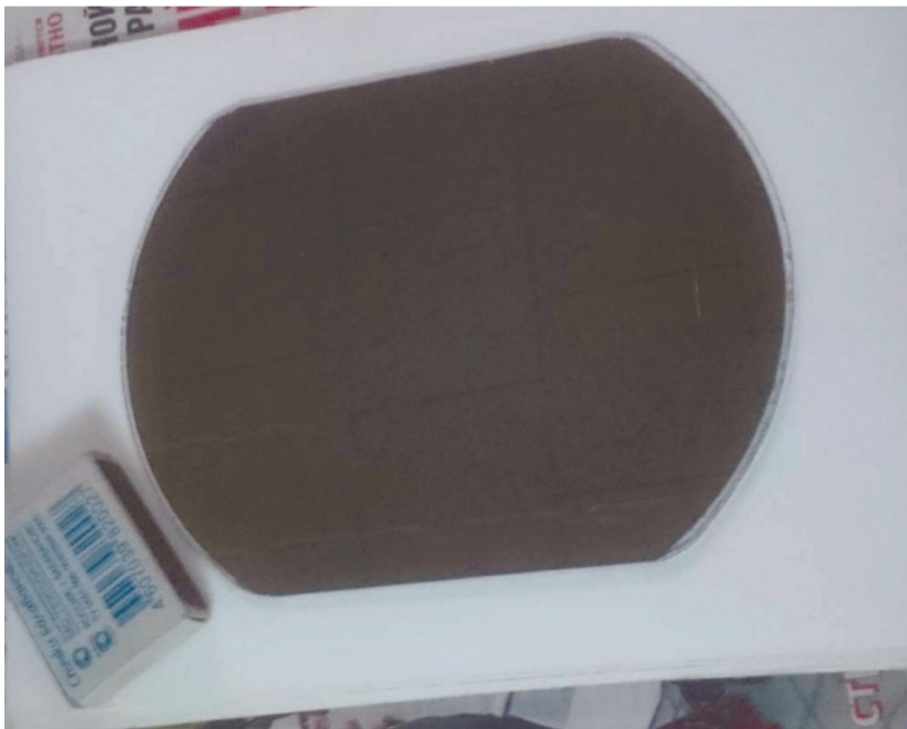
Рис. 6. Фотография пленки низкотемпературного полупроводника Р-типа на стекле; диаметр напыления 165 мм, толщина \Delta \approx 2,5 мкм
