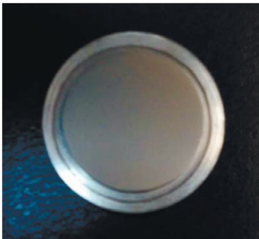
Рис.3. Фотография диска из алюминия с нанесенной на его поверхности полупроводниковой пленкой Р – типа. Диаметр изделия 30 мм; диаметр нанесенной пленки – 22 мм.
