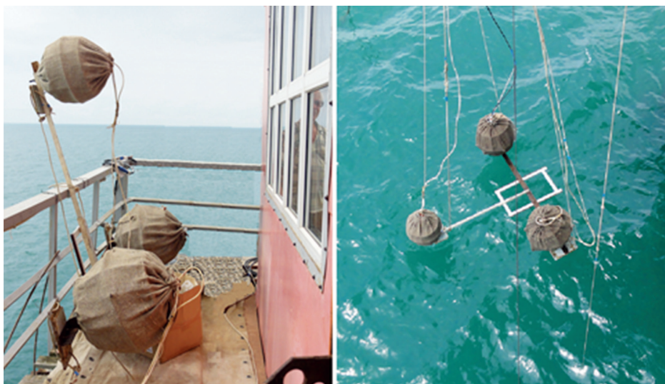
Рисунок 5. Общий вид трехэлементной приемной системы – слева; вид системы на поверхности перед постановкой на дно – справа
