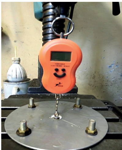
Рисунок 3. Стенд испытаний на адгезию коммутационных пленок, нанесенных на поверхности алюминия и молибдена
