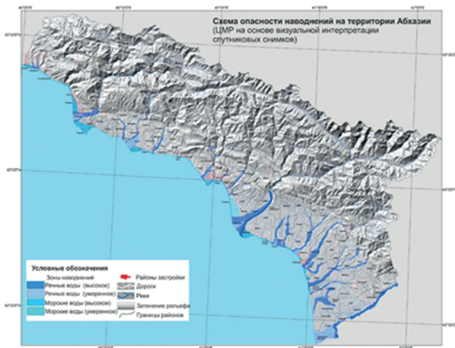
Рисунок 16. Схема опасности наводнений на территории Абхазии, сформированная путем интерпретации затенения холма на ЦМР
