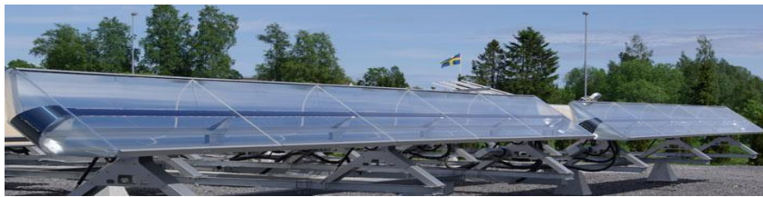
Рисунок 29. Гибридный ФЭНУ, созданный на базе КС-ЛР и ФЭМ
