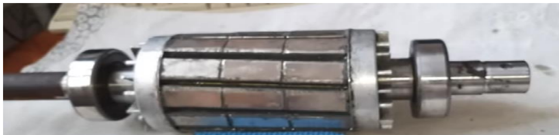
Рисунок 22. Ротор АГ с неодимовыми магнитами имеющий улучшенные характеристики по мощности
