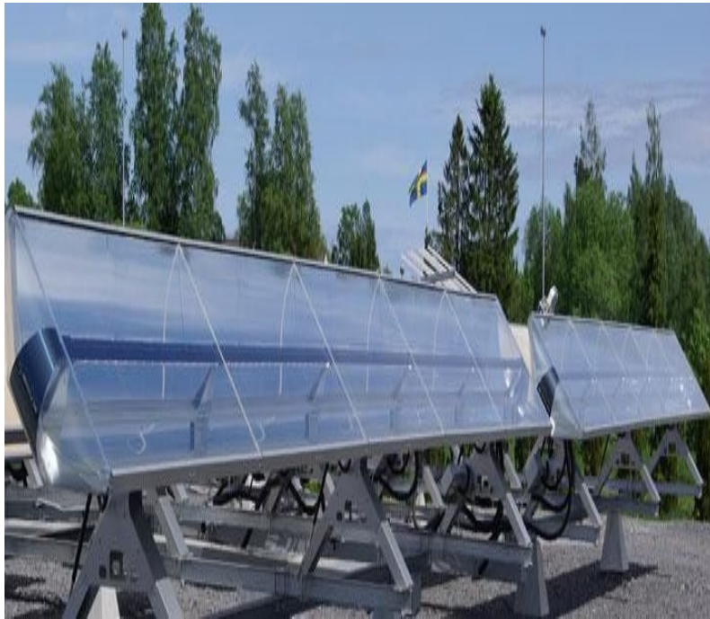
Рисунок 3.3.6. Гибридный ФЭНУ, созданный на базе КС-ЛР и ФЭМ
