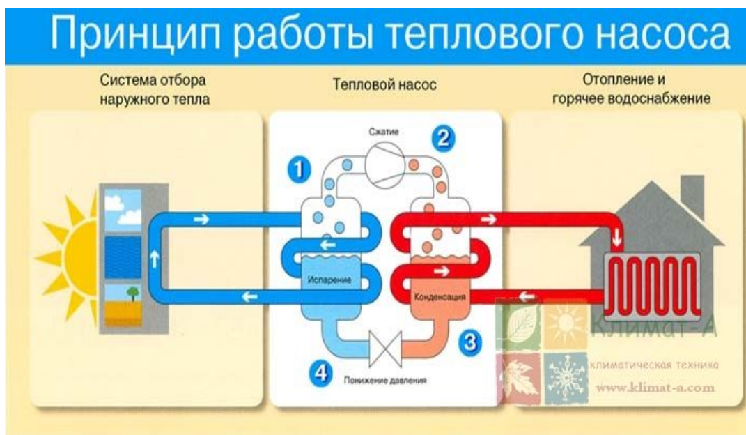
Рисунок 1.5.1. Схематическое изображение работы ТН
