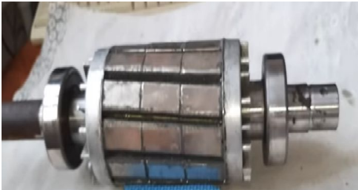
Рисунок 2.12.5. Ротор АГ с неодимовыми магнитами имеющий улучшенные характеристики по мощности
