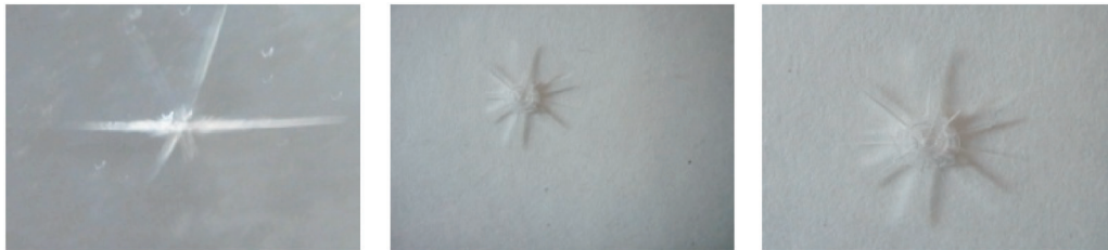
Рисунок 3.5. Фото частиц алюминия ( \varnothing 2,5 мм; h 2,5 мм) после воздействия на медную пластину (а); скорость частицы v \approx 400 м/с. Рисунок 3.5б, в – фото частиц после воздействия частицы алюминия ( \varnothing 1,7 мм; h 1 мм) на пластину органического стекла ( v \approx 500 м/с). Квадрат на бумаге соответствует площади 5 \cdot 5 мм 2 . Толщина медной пластины \Delta = 3 мм; органического стекла – \Delta = 2 мм
