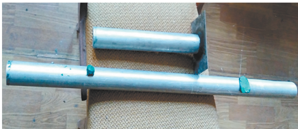
Рисунок 3.4.1а. Фото титановых труб, используемых в эксперименте; пластилин фиксировал трубу на ее основе; сверху труба совмещена с прямоугольной стальной мишенью – пластиной
