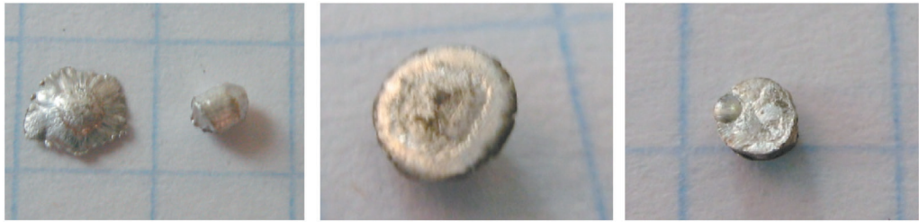
Рисунок 3.5. Фото частиц алюминия ( \varnothing 2,5 мм; h 2,5 мм) после воздействия на медную пластину (а); скорость частицы v \approx 400 м/с. Рисунок 3.5б, в – фото частиц после воздействия частицы алюминия ( \varnothing 1,7 мм; h 1 мм) на пластину органического стекла ( v \approx 500 м/с). Квадрат на бумаге соответствует площади 5 \cdot 5 мм 2 . Толщина медной пластины \Delta = 3 мм; органического стекла – \Delta = 2 мм
